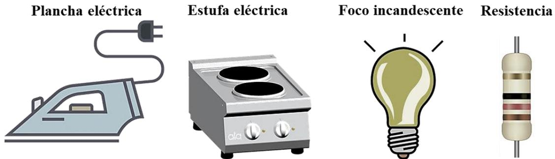
**Figura 20:** Dispositivos eléctricos considerados como elementos resistivos en un circuito
