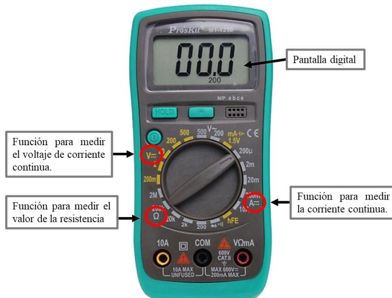
**Figura 19:** Multímetro digital que integra todas las funciones que ilustra la figura 18
