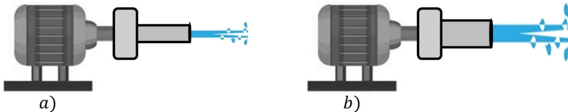
**Figura 24:** Las tuberías con un diámetro menor generan una presión significativa.
