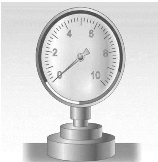
El manómetro es un dispositivo que se utiliza para medir la presión.
