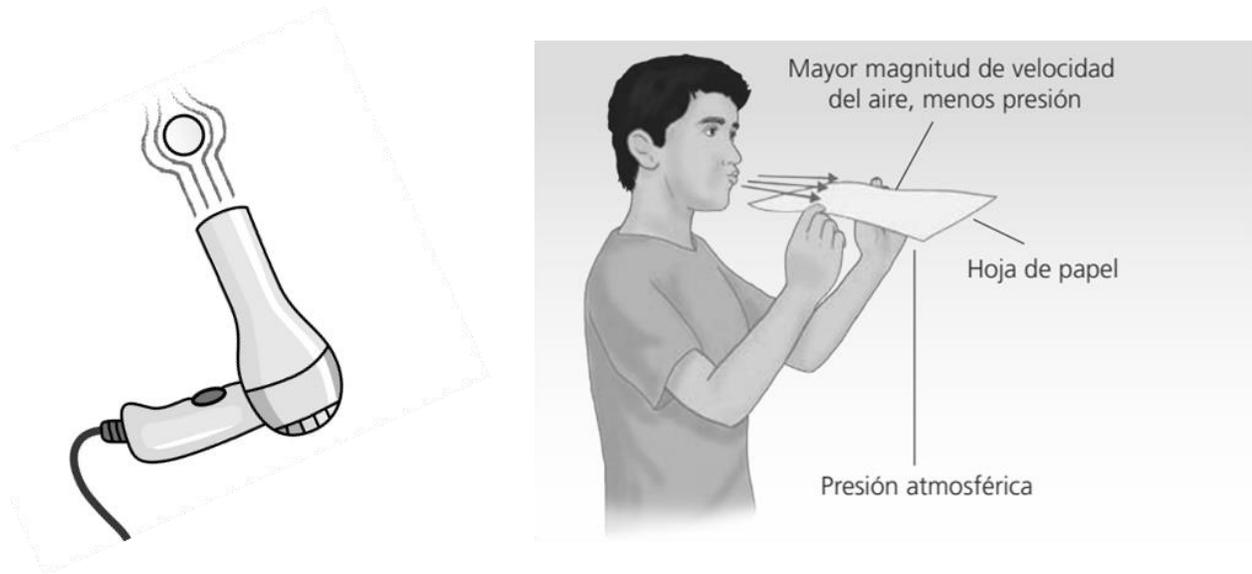
**Figura 25:** Experimentos que comprueban el principio de Bernoulli
